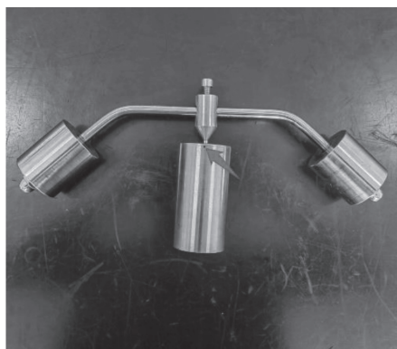
图1 球压装置底座预留热电偶孔
